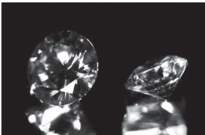
(2) Diamanteinkristalle aus dem CVD-Prozess. Links: Diamantschicht auf HTHP-Substrat nach dem Abscheideprozess, etwa 5 mm hoch, 10 mm Durchmesser. Rechts: Einkristall in optischer Qualität als Brillant geschliffen, 0,5 ct.
